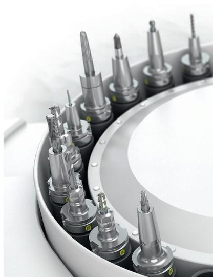
**3** Die 'Zoller Tooling Solutions' sind mit einem 'idChip' ausgestattet, der ein wichtiger Schritt in Richtung Digitalisierung ist. Mithilfe des DataMatrix-Codes können alle Werkzeugaufnahmen durch einfaches Scannen sofort erkannt und identifiziert werden © E. Zoller
